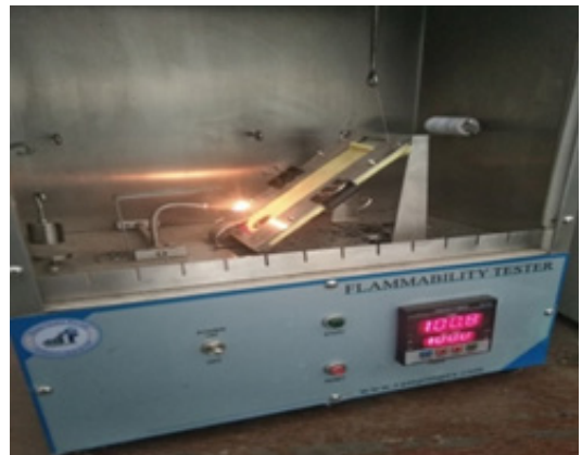
चित्र 3 45° वर्टिकल पलैमअबिलिटी टेस्टिंग मशीन (HPT Pvt. Ltd. Haryana)
